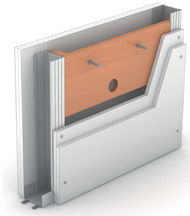
Sanitaire apparaten worden aan ingebouwde hulpconstructies bevestigd.
